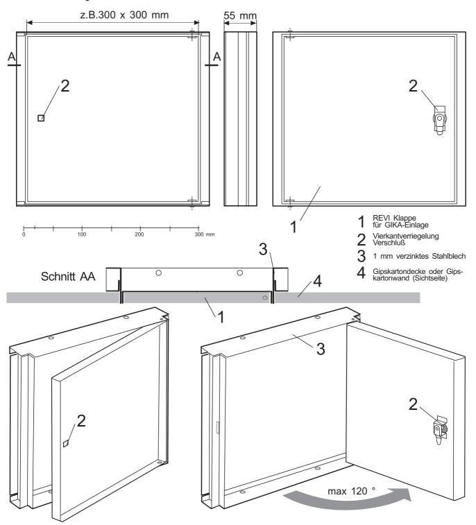
intrasan-REVI-Klappe aus 1 mm verzinkten Stahlblech für oder mit z.B. 12.5 mm GIKA-Einlage Vierkantverriegelung auch mit Automatik-Federschnapp-Verschluß (Mini-Latch) lieferbar! Die oben beschriebene REVI-Klappe ist bis 43 mm GIKA-Einlage lieferbar!
