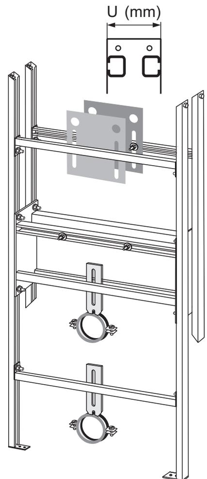
intrasan® Waschtisch-Universal-Tragständer für beidseitige Waschtischmontage mit oberer Quertaverse und Montageplatte für Wandarmatur, mit Gewindebolzen für Waschtischbefestigung, 2 Rohrschellenhalterungen 40-60 mm für Abfluß
