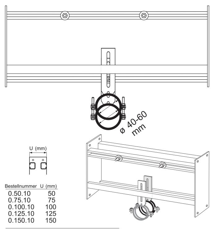
intrasan® Traverse für beidseitige Waschtischmontage zur Verschraubung mit UA-Profil mit Gewindebolzen für Waschtisch-Befestigung und 2 Rohrschellenhalterungen 40-60 mm für Abfluß
