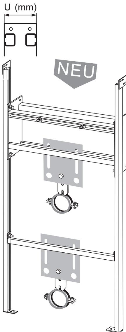
intrasan® Waschtisch-Universal-Tragständer für beidseitige Waschtischmontage mit Gewindebolzen für Waschtischbefestigung, 2 Rohrschellenhalterungen 40-60 mm für Abfluß und 2 Montageplatten für Eckventile für Kalt-Warmwasser
