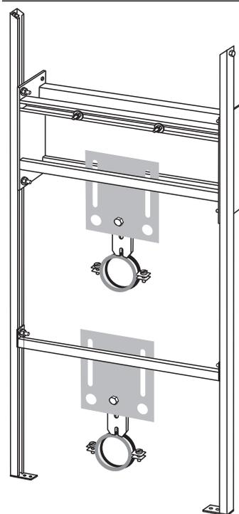
intrasan<sup>®</sup> Waschtisch-Universal-Tragständer für beidseitige Waschtischmontage mit Gewindebolzen für Waschtischbefestigung, 2 Rohrschellenhalterungen 40-60 mm für Abfluß und 2 Montageplatten für Eckventile für Kalt-Warmwasser
