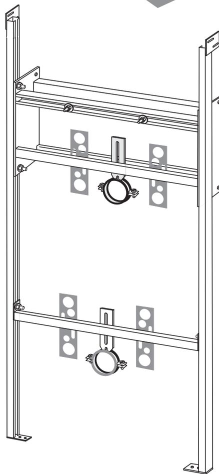
intrasan® Waschtisch-Universal-Tragständer für beidseitige Waschtischmontage mit Gewindebolzen für Waschtischbefestigung, 2 Rohrschellenhalterungen 40-60 mm für Abfluß und 4 Montageplatten mit den Bohrungen Ø 18 - 23 - 27 - 32 mm
