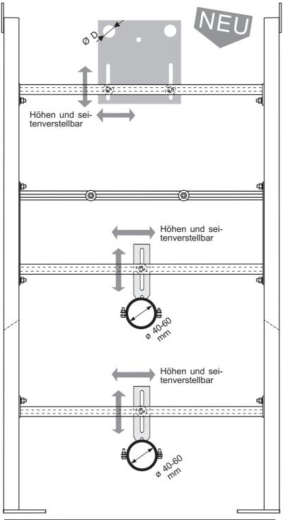
intrasan Waschtisch-Universal-Tragständer für beidseitige Waschtischmontage mit oberer Quertraverse und Montageplatte für Wandarmatur, mit Gewindebolzen für Waschtischbefestigung, 2 Rohrschellenhalterungen 40-60 mm für Abfluß
