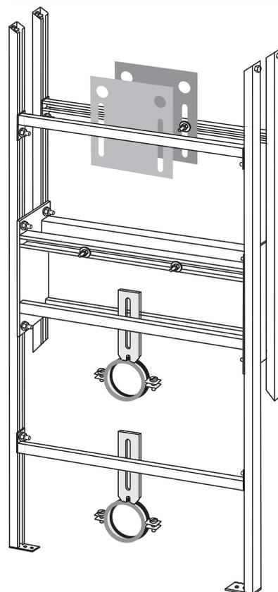
intrasan® Waschtisch-Universal-Tragständer für beidseitige Waschtischmontage mit oberer Quertraverse und Montageplatte für Wandarmatur, mit Gewindebolzen für Waschtischbefestigung, 2 Rohrschellenhalterungen 40-60 mm für Abfluß
