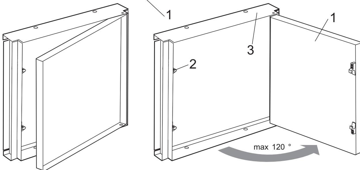
intrasan-REVI-Klappe aus 1 mm verzinkten Stahlblech für oder mit z.B. 12.5 mm GIKA-Einlage mit Automatik-Federschnappverschluss (Mini-Latch)
